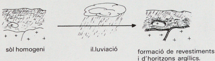
Fig. 9.— En un sòl no il.luviat, l'argila està uniformement repartida en tot el gruix. La pluja, o el rec, l'acumulen en un horitzó B_1 i en revestiments que recobreixen la roca mare i els elements gruixuts.
