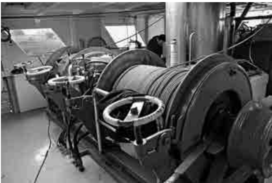
Torns hidràulics de l'embarcació Gacela per a la recollida de les xarxes en pesca d'arrossegament. Procedència i autor: Josep M. Vicens
