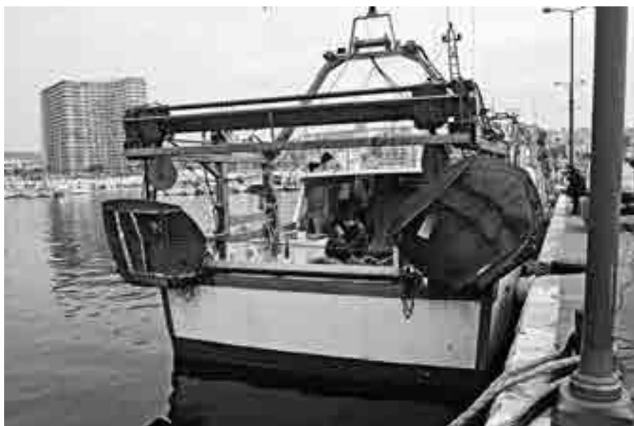
Portes en la popa d'una embarcació de pesca d'arrossegament a Palamós. Procedència i autor: Josep M. Vicens
